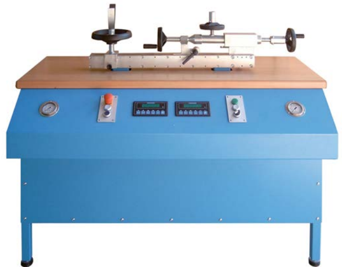
Mobile Pulverumfüllmaschine PFF-SUMATIC-V40 · Nr. 113 000
